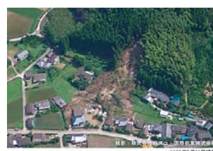
被災現場写真 (提供:株式会社バスコ・ 国際航業株式会社) 鹿児島県伊佐郡菱刈 町下手仲間で発生した シラス斜面の崩壊。一 人の犠牲者がでました
